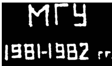
Рис.3. Надпись, сделанная в лаборатории МГУ электронным пучком на пленке GaN. Пленка была выращена из газовой фазы и легирована акцептором Zn. Ширина линий — 2 мкм.
