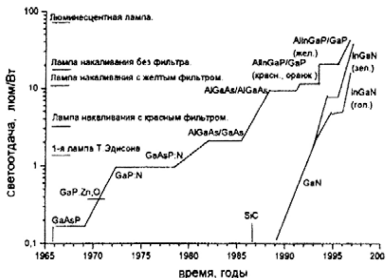
Рис.2. Светоотдача (в люменах на ватт) для светодиодов из различных материалов в зависимости от года разработок.
