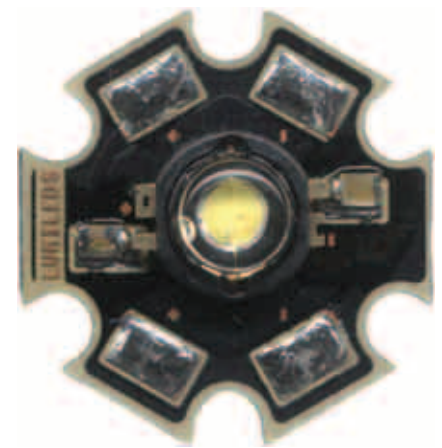
Рис. 7. Внешний вид белого светодиода Luxeon Star
