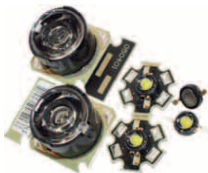
Рис. 9. Излучатели (слева направо): Luxeon Star/O с интегрированной вторичной оптикой, Luxeon Star и Luxeon Emitter
