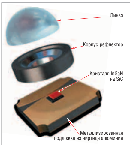
Рис. 5. Конструкция СЛ компаний CREE
