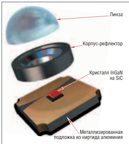
Рис. 5. Конструкция СЛ компаний CREE
